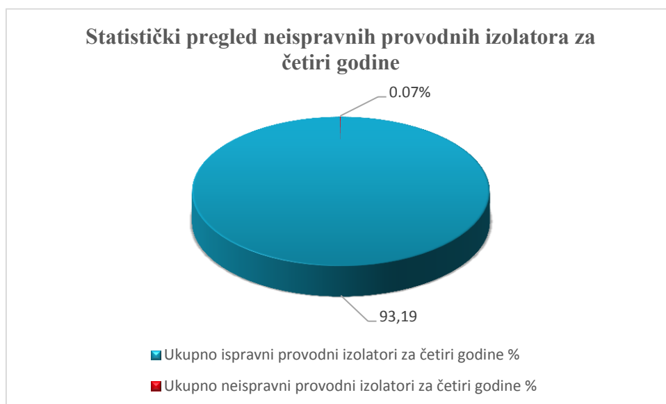
Slika 6 - Statistički pregled neispravnih provodnih izolatora 2013.-2016. godine
